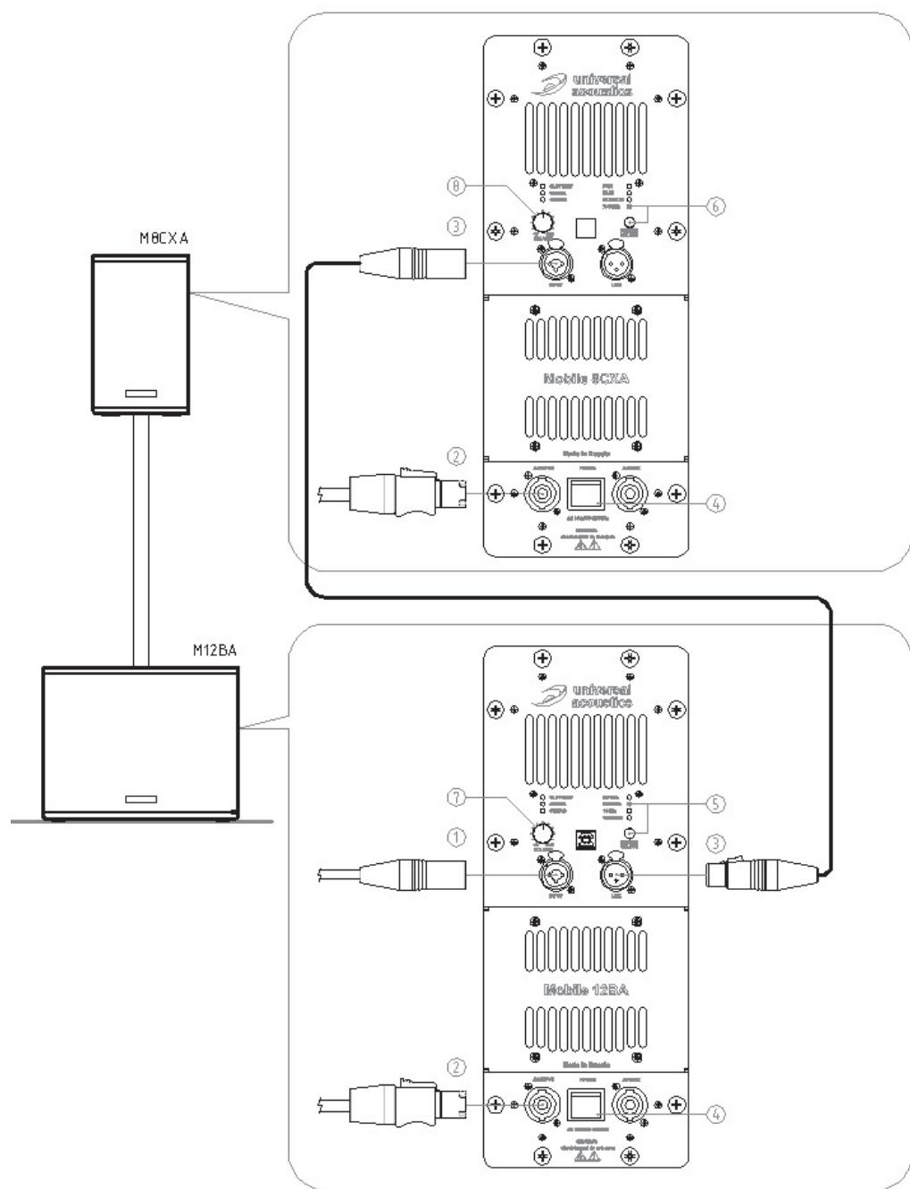
Пресет **X-OVER** - оптимизирован для работы с активной низкочастотной акустической системой **Mobile 12BA**.
