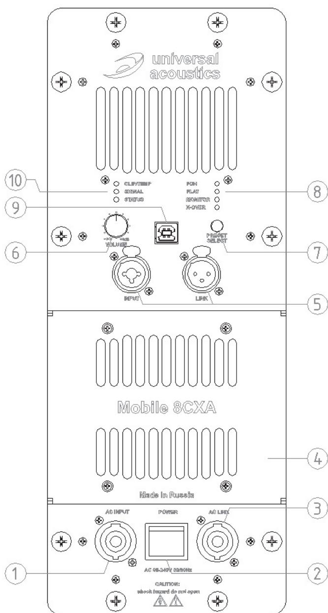
Поз.1 - **AC INPUT** – разъем для подключения сетевого кабеля ~220/230В, 50/60Гц.
